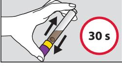
**7** Agiter le tube scellé, le plus fort et vite possible, par un mouvement de va-et-vient pendant **au moins 30 secondes.**
