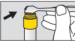
**5** Gratter horizontalement au-dessus de la jupe du tube pour mettre à niveau l'échantillon et éliminer tout excès.
