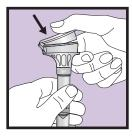
D'une main, tenir le tube à la verticale. De l'autre, fermer le bouchon (comme indiqué) en le poussant fermement jusqu'à ce qu'un claquement fort se fasse entendre. Le liquide se trouvant dans le bouchon sera libéré dans le tube et se mélangera à l'échantillon. S'assurer que le bouchon est hermétiquement fermé.
