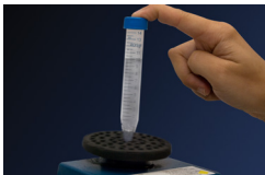
Figura 6: Se agitar a amostra no vórtex por 30 segundos, poderá recuperar o ADN presente na parte lateral do tubo. O ADN continuará a ter um peso molecular elevado.
