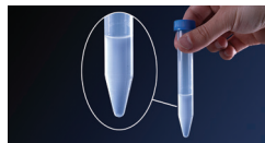
Figura 1: Qabel ma tipproċedi għall-pass 4, kun żgur li l-kampjun kollu gie inkubat u trasferit għal tubu taċ-ċentrifugu frisk ta' 15 mL, kif muri.
