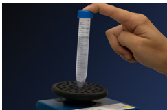
Figura 6: Il-vortexing tal-kampjun għal 30 sekonda jippermettitek tirkupra DNA m'assapsa fuq in-naħa tat-tubu. Id-DNA se jibqa' ta' piz molekulari għoli.
