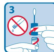
Удерживая пробирку вертикально, отвинтите колпачок пробирки.
