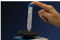
Fíor 6: Ach an sampla a chur sa mheascthóir cuilithe ar feadh 30 soicind, beidh tú in ann DNA atá smeartha ar thaobh an fheadáin a bhailiú. Beidh an DNA fós ar ard-mhéachan móilíneach.
