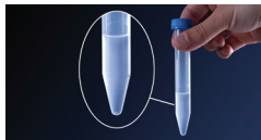
Kuva 1: Ennen kuin jatkat vaiheeseen 4, varmista, että olet inkuboinut koko näytteen ja siirtänyt sen uuteen 15 ml:n sentrifugiputkeen tässä kuvatulla tavalla.
