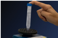
Фигура 6: Вортексирането на пробата 30 секунди ще Ви позволи да възстановите ДНК от намазката от страни на епруветката. ДНК ще остане с високо молекулно тегло.
