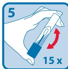
Invertire la provetta con cappuccio e agitare energicamente per 15 volte.
