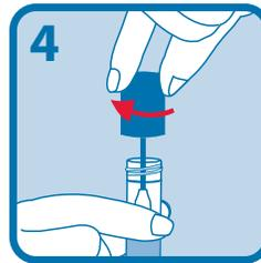
Posizionare il cappuccio a testa in giù, inserire la spugna nella provetta e chiudere il tappo ermeticamente.
