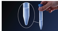
Figura 1: prima di procedere al passaggio 4, assicurarsi che l'intero campione sia stato incubato e trasferito in una provetta per centrifuga pulita da 15 ml, come mostrato.
