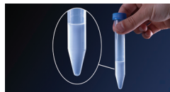
1. ábra: A 4. lépés előtt győződjön meg arról, hogy a teljes mintát inkubálta, és a képen látható módon egy új, 15 ml-es centrifugacsöbe helyezte át.
