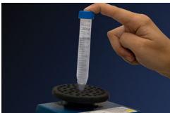
Figur 6: At omryste prøven i 30 sekunder vil give mulighed for at genvinde DNA, der er sidder på siden af røret. DNA'et vil forblive højmolekylært.
