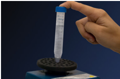
Figure 6 : Mélanger l'échantillon au vortex pendant 30 secondes permettra de récupérer la trainée d'ADN sur la paroi du tube. L'ADN conservera un poids moléculaire élevé.
